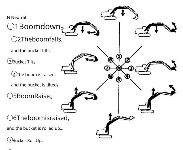
8The boom drops and the bucket rolls up。
